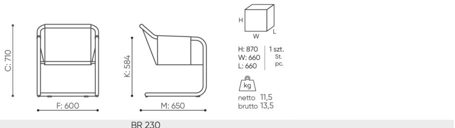
B **hauteur d'assise:** mesur e selon la norme PN EN 1335-1 avec une charge de 640N
