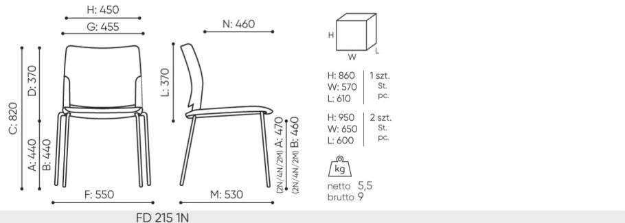
B **hauteur d'assise:** mesur e selon la norme PN EN 1335-1 avec une charge de 640N
