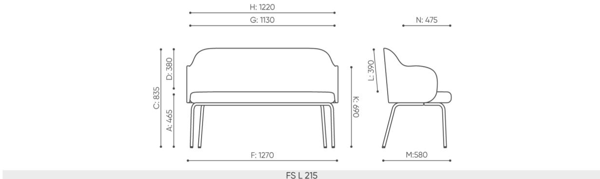
B **hauteur d'assise:** mesur e selon la norme PN EN 1335-1 avec une charge de 640N
