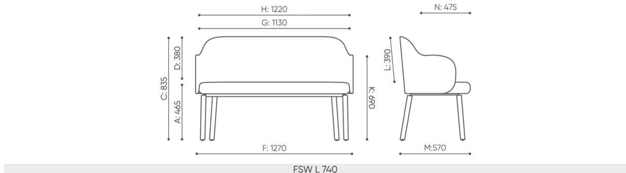
B **hauteur d'assise:** mesur e selon la norme PN EN 1335-1 avec une charge de 640N
