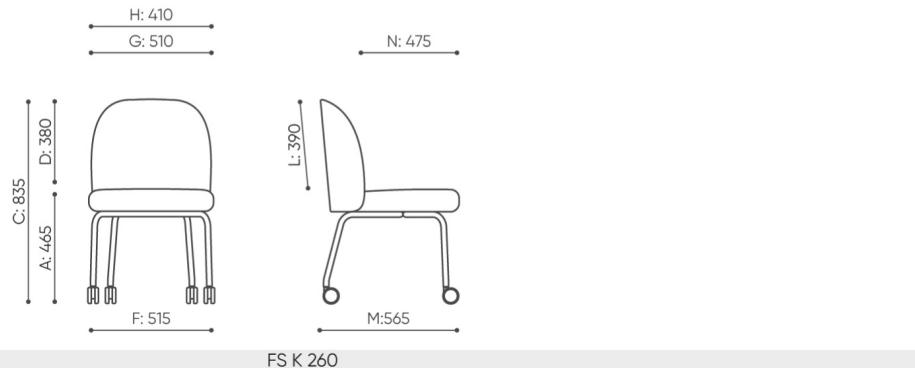
B **hauteur d'assise:** mesur e selon la norme PN EN 1335-1 avec une charge de 640N
