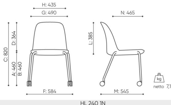
B **hauteur d'assise:** mesur e selon la norme PN EN 1335-1 avec une charge de 640N
