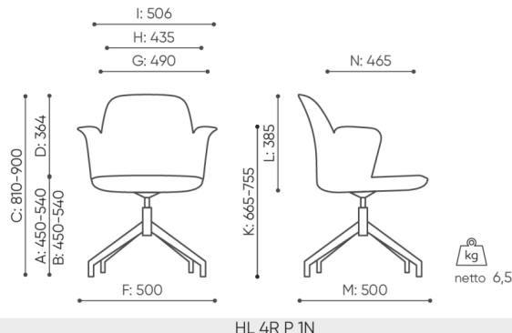
B **hauteur d'assise:** mesur e selon la norme PN EN 1335-1 avec une charge de 640N
