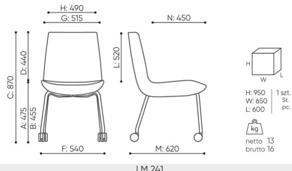
B **hauteur d'assise:** mesur e selon la norme PN EN 1335-1 avec une charge de 640N
