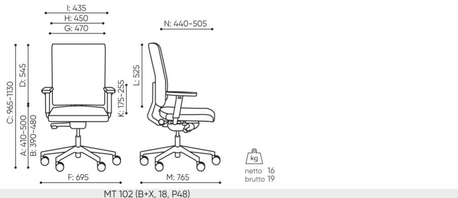
B **hauteur d'assise:** mesur e selon la norme PN EN 1335-1 avec une charge de 640N
