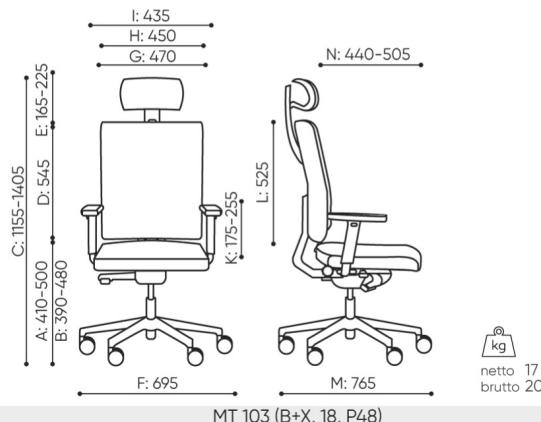
B **hauteur d'assise:** mesur e selon la norme PN EN 1335-1 avec une charge de 640N
