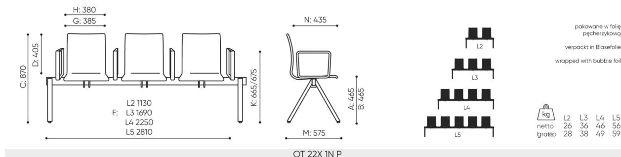
B **hauteur d'assise:** mesurée selon la norme PN EN 1335-1 avec une charge de 640N
