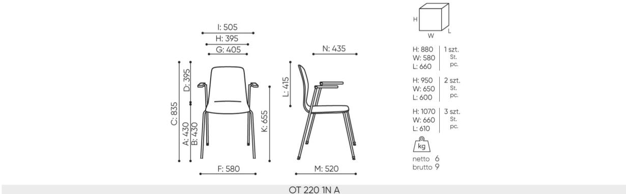
B **hauteur d'assise:** mesur e selon la norme PN EN 1335-1 avec une charge de 640N
