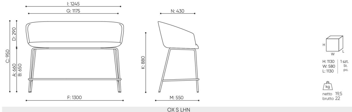
B **hauteur d'assise:** mesurée selon la norme PN EN 1335-1 avec une charge de 640N
