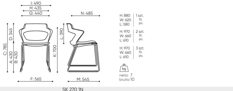
B **hauteur d'assise:** mesur e selon la norme PN EN 1335-1 avec une charge de 640N
