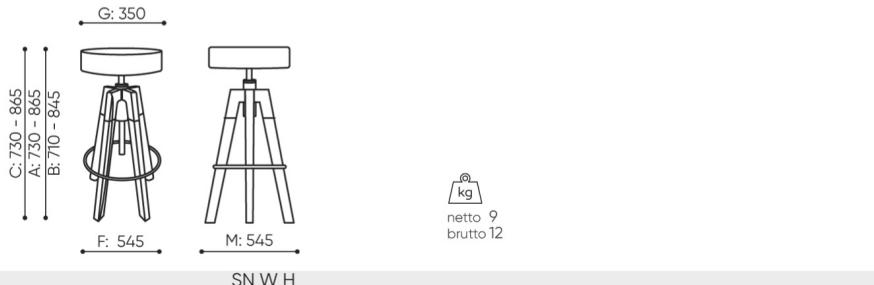
B **hauteur d'assise:** mesur e selon la norme PN EN 1335-1 avec une charge de 640N
