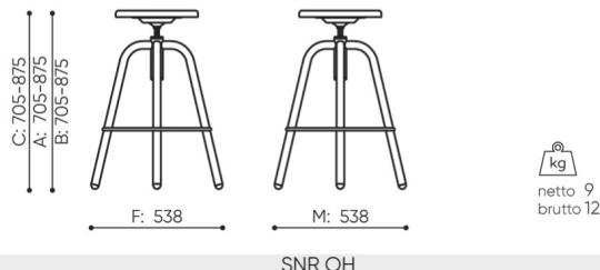
B **hauteur d'assise:** mesur e selon la norme PN EN 1335-1 avec une charge de 640N
