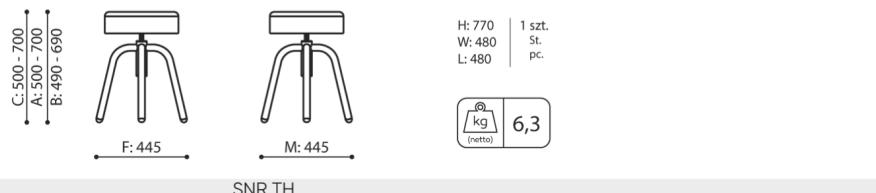
B **hauteur d'assise:** mesur e selon la norme PN EN 1335-1 avec une charge de 640N
