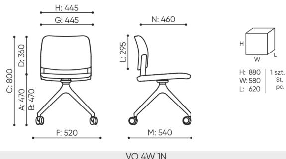
B **hauteur d'assise:** mesur e selon la norme PN EN 1335-1 avec une charge de 640N
