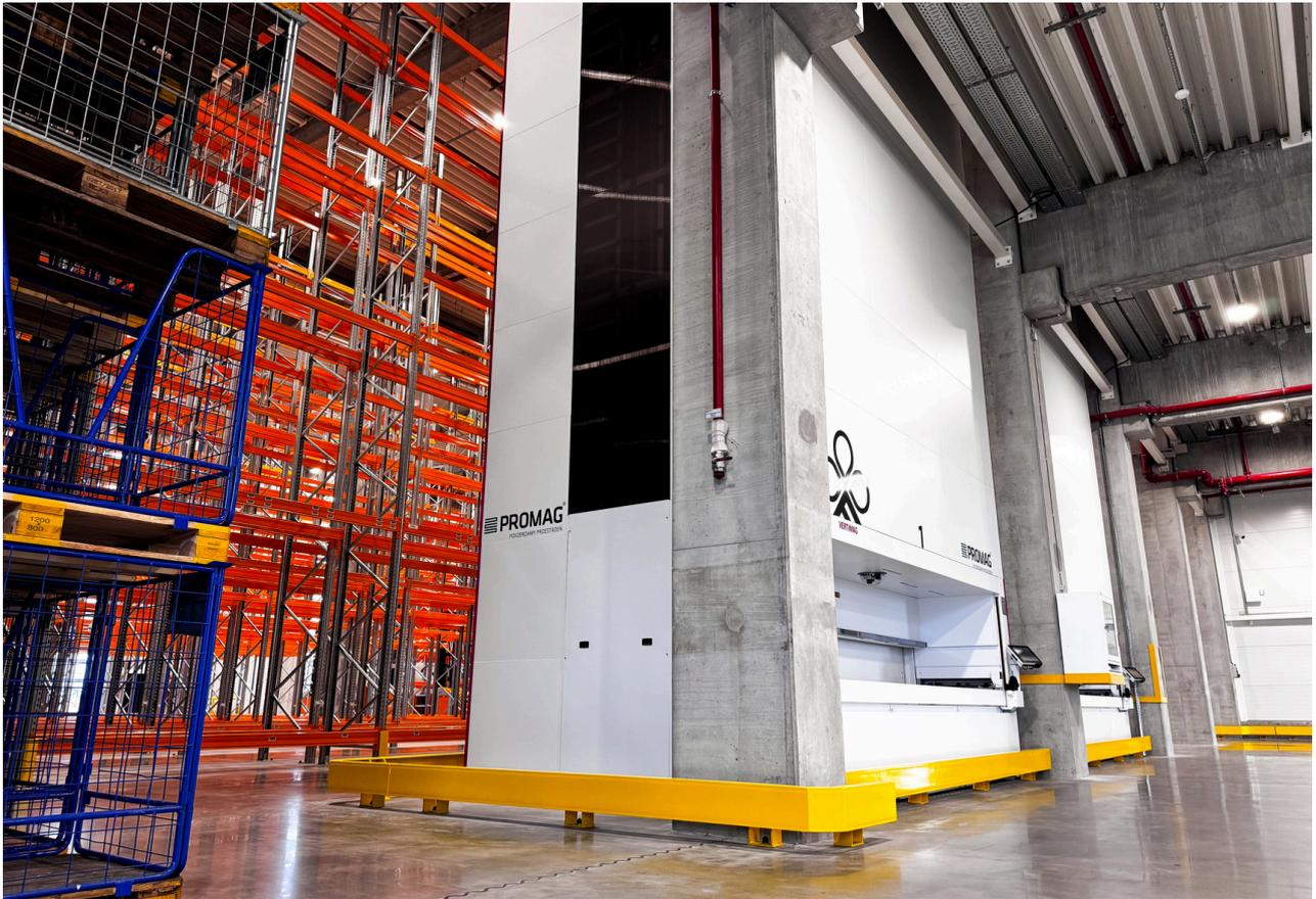
Die Infrastruktur wird durch zwei automatisierte Vertimag-Vertikalhubmodule weiter verbessert. Dieses fortschrittliche Lagersystem integriert die Prozesse der Lagerung, Kommissionierung und Auslieferung von Waren, nutzt die Höhe der Anlage voll aus und erzielt maximale Lagerkapazität bei minimalem Platzbedarf.
